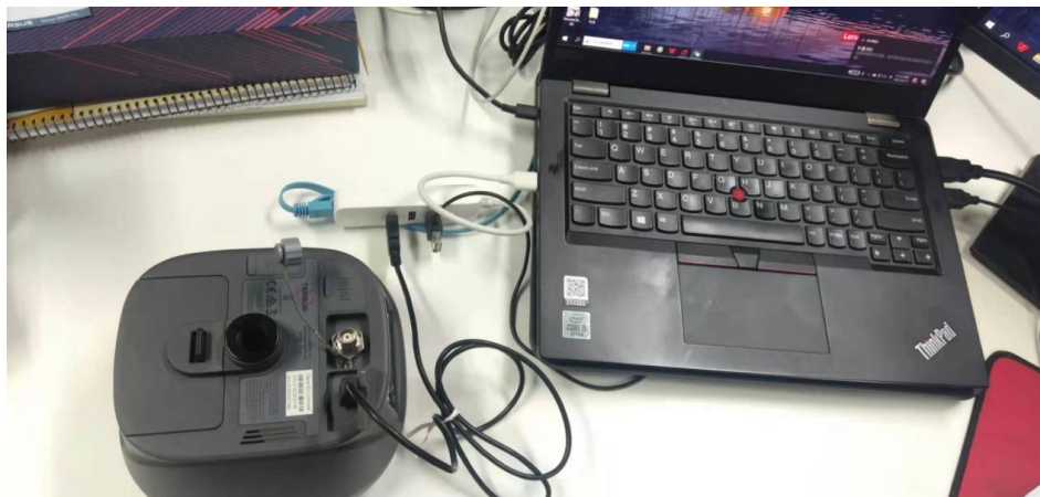
图 2.27 Mini USB 线连接奥斯卡与电脑
